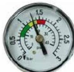
1,3 kg/cm<sup>2</sup> - 18,5 PSI: Der Druck beträgt 0,5 kgs/cm<sup>2</sup> mehr als der Anfangsdruck. Das bedeutet, dass eine REINIGUNG notwendig ist.
